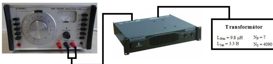
Obrázok 5: Konštrukcia HV zdroja – Farnell oscillator lfm4, zosilňovač EP2000, vysokonapäťový transformátor
