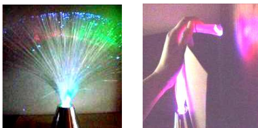
Obr.3 Dekoračná lampa so zväzkom optických vlákien
