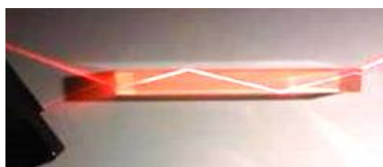
Obr.5 Pokus s hranolom - lúč sa odráža od rozhrania plexisklo – vzduch
